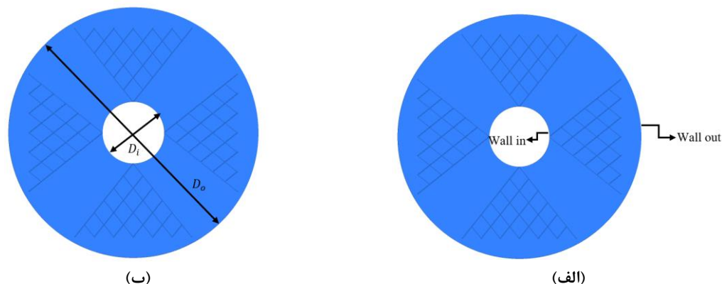
شکل ۲ الف) شرایط مرزی و ب) مشخصات هندسی مبدل سه لوله‌ای
