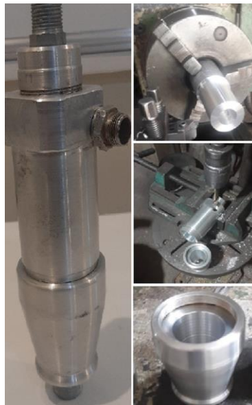
شکل ۴ مراحل ساخت و برهم‌بندی سامانه‌ی جداساز هوا از روغن هیدرولیکی
