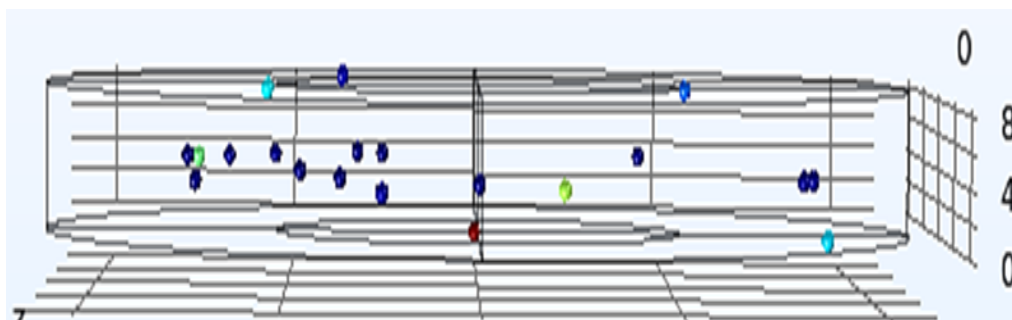
شکل ۳ محل قرارگیری ذرات رهاشده در گپ تعلیق پس از طی ۱۰ ثانیه
