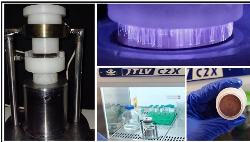
شکل ۷ بخش‌های مختلف DBD و ایجاد پلاسما پس از راه‌اندازی سیستم
