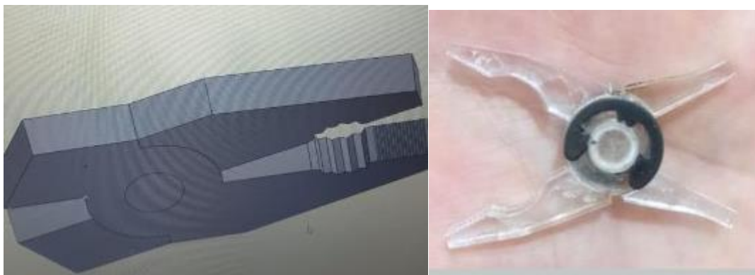
شکل ۷ گیره طراحی‌شده جهت گیرایش و رهایش قطعه
