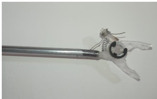
شکل ۸ نمونه اولیه عملگر ساخته شده مجهز به پلیمر حافظه دار
