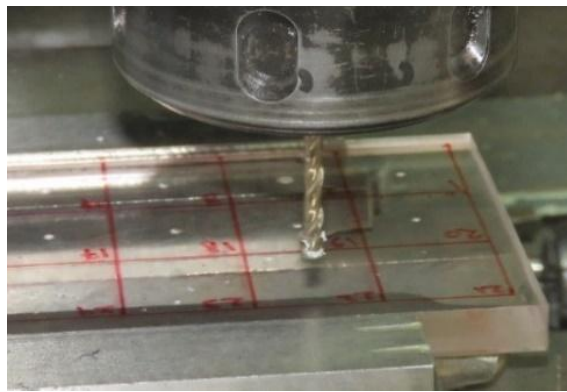
شکل ۲ پلی متیل متاکریلات در حال سوراخ‌کاری [۱۴]
