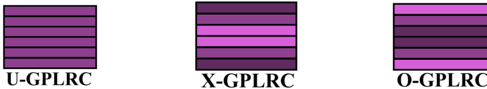
شکل ۲ الگوهای توزیع متقارن نانو پلاکت‌های گرافنی در تیر کامپوزیتی.
