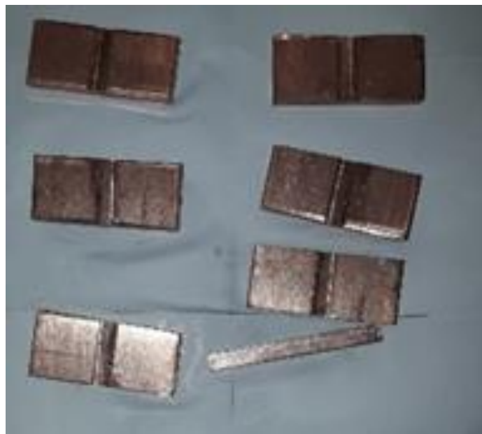
شکل ۴ تصویر قطعات جوشکاری شده پس از تزریق پودر. (الف) عمق کم و عرض زیاد، (ب) عمق کم و عرض کم، (ج) خراش‌های سطحی.
