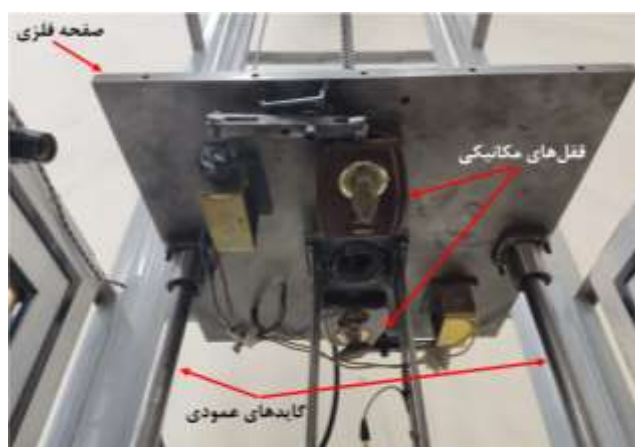
شکل ۸ نمایی از متعلقات دستگاه سقوط وزنه
