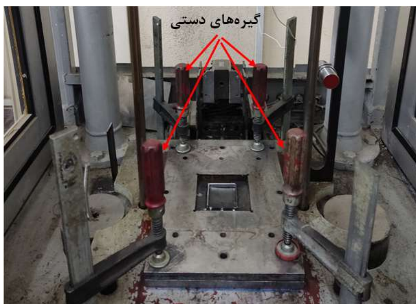
شکل ۱۶ فیکسچر و گیره‌های دستی محکم‌کننده‌ی آن
