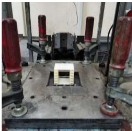
شکل ۱۷ نحوه قرارگیری یکی از نمونه‌ها برای انجام تست ضربه
