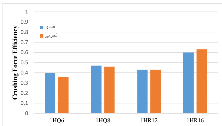
شکل ۴۲ نمودار بازده نیروی لهیدگی نمونه‌ها در حالت عددی و تجربی
