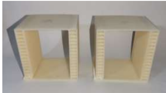
شکل ۳۵ نمونه‌های 1HR16 پس از انجام تست ضربه و ایجاد تغییر شکل در آنها
