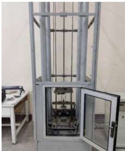
شکل ۷ دستگاه سقوط وزنه دانشگاه صنعتی امیرکبیر
