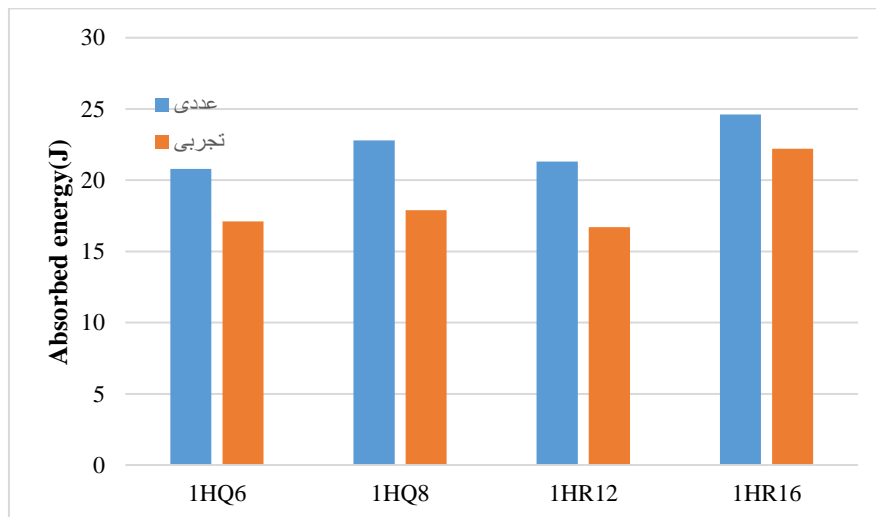
شکل ۴۰ نمودار انرژی تعادلی نمونه‌ها در حالت عددی و تجربی
