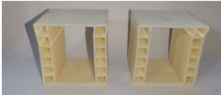
شکل ۲۰ نمونه‌های 1HQ6 پس از انجام تست ضربه و ایجاد تغییر شکل در آن‌ها.
