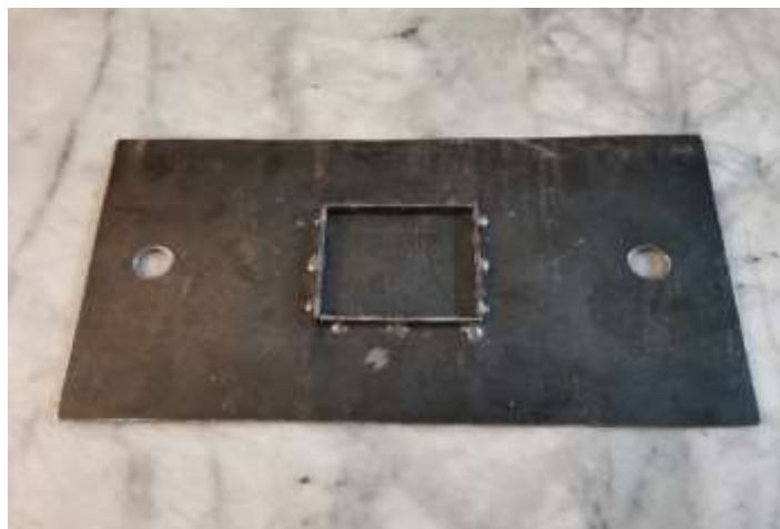
شکل ۱۵ فیکسچر ساخته شده
