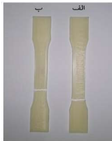
شکل ۶ نمونه‌های استاندارد ساخته شده و تست شده (الف) پرینت شده در جهت ۰ درجه (ب) پرینت شده در جهت ۹۰ درجه.
