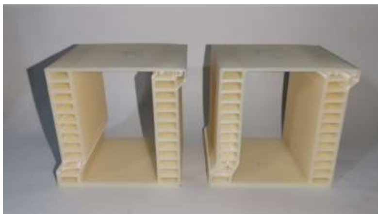
شکل ۳۰ نمونه‌های 1HR12 پس از انجام تست ضربه و ایجاد تغییر شکل در آن‌ها
