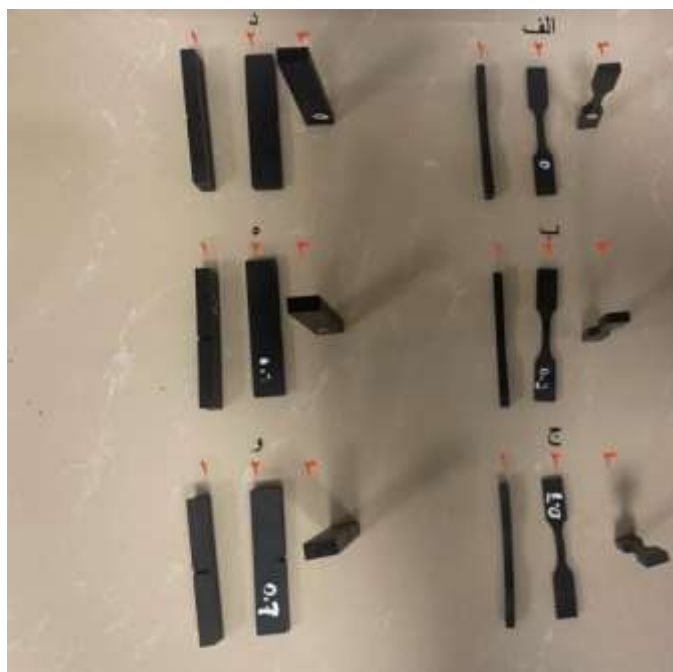
شکل ۲ نمونه‌های تولید شده با استفاده از ساخت افزایشی (الف) نمونه کشش با بدون اکسیدگرافن در سه جهت، (ب) نمونه ضربه بدون اکسیدگرافن، (ج) نمونه کشش با ۰/۳ درصد اکسیدگرافن، (د) نمونه ضربه با ۰/۳ درصد اکسیدگرافن، (ه) نمونه تست کشش با ۰/۷ درصد اکسیدگرافن، (و) نمونه تست ضربه با ۰/۷ درصد اکسیدگرافن
