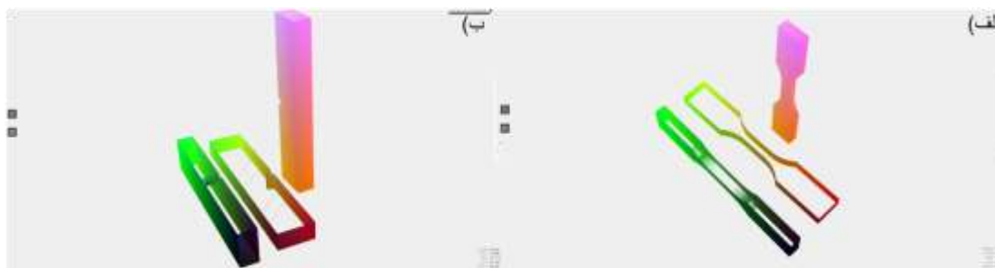
شکل ۱ نحوه قرارگیری نمونه‌ها در طراحی در نرم‌افزار اسلایسر (الف) آزمون کشش، (ب) آزمون ضربه.
