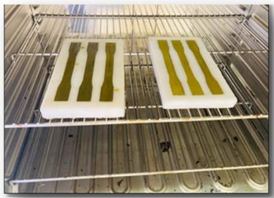
شکل ۱ محلول ریخته شده در قالب های دمبلی شکل بر اساس استاندارد ASTM D638
