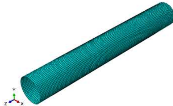
شکل ۱ نمایی از المان‌بندی صورت‌گرفته برای شافت در نرم‌افزار آباکوس
