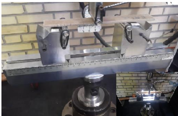
شکل ۳ قطعه کامپوزیتی در حین آزمایش خمش سه نقطه‌ای.
