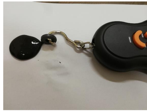
شکل ۴ آزمایش نیرو-جابجایی با آهنربای ۱۷۰۰ گوس
