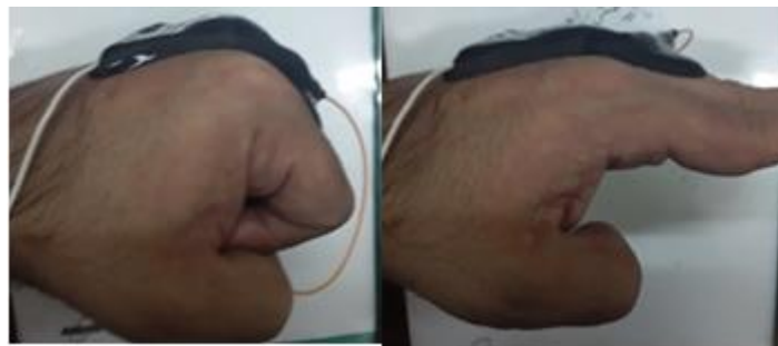
شکل ۱۰ استفاده از نانو اسلایم برای ثبت و اندازه‌گیری حرکت در اندام انسانی
