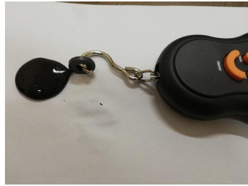
شکل ۴ آزمایش نیرو-جابجایی با آهنربای ۱۷۰۰ گوس
