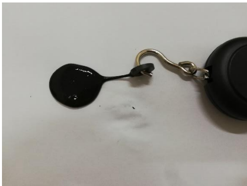
شکل ۴ آزمایش نیرو-جابجایی با آهنربای ۱۷۰۰ گوس
