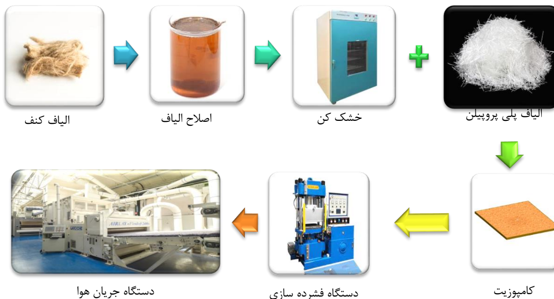
شکل ۱ مراحل تولید کامپوزیت تقویت شده پروپیلن به وسیله کنف
