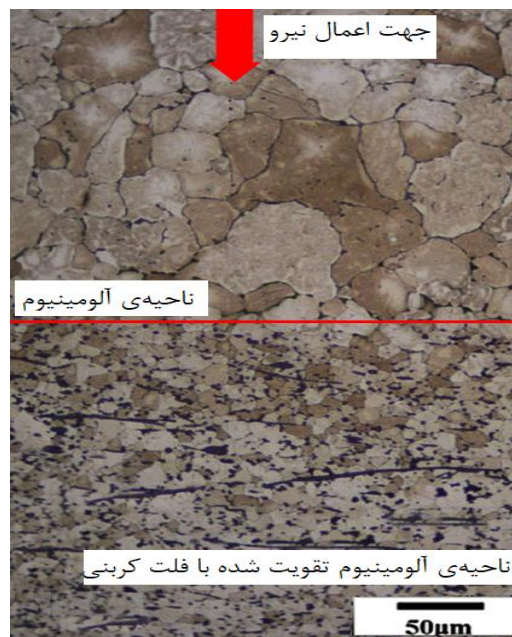
شکل ۱۲ تصویر میکروسکوپ نوری مربوط به نمونه‌ی کامپوزیتی تقویت شده با فلت کربنی (قسمت پایین تصویر) و نمونه‌ی شاهد آلومینیومی (قسمت بالای تصویر).
