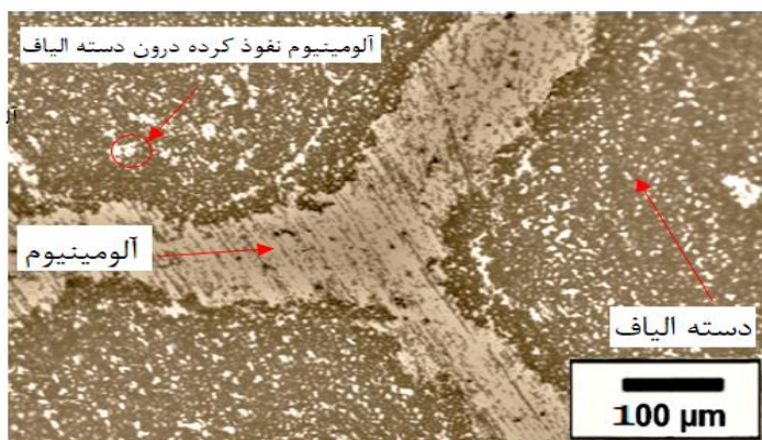
شکل ۱۴ تصویر میکروسکوپ نوری از مقطع نمونه‌ی کامپوزیتی آلومینیوم-کربن دارای پوشش فسفر-نیکل.
