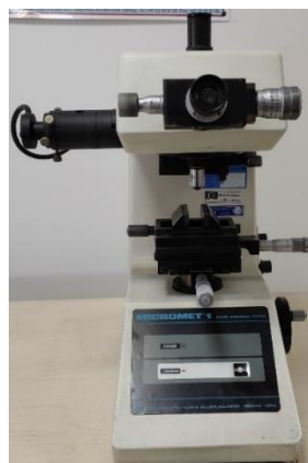
شکل ۴ دستگاه سختی سنجی 1 Buehler MICROMET
