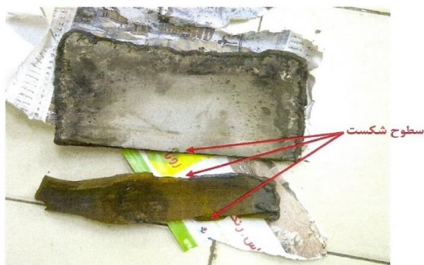
شکل ۲ نمایی از سطوح شکست نمونه مورد مطالعه
