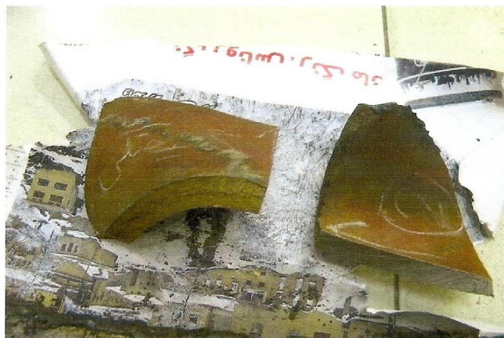
شکل ۶ آثار زنگ‌زدگی در سطح داخلی
