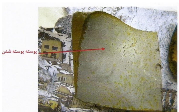
شکل ۷ آثار پوسته‌پوسته شدن در سطح خارجی
