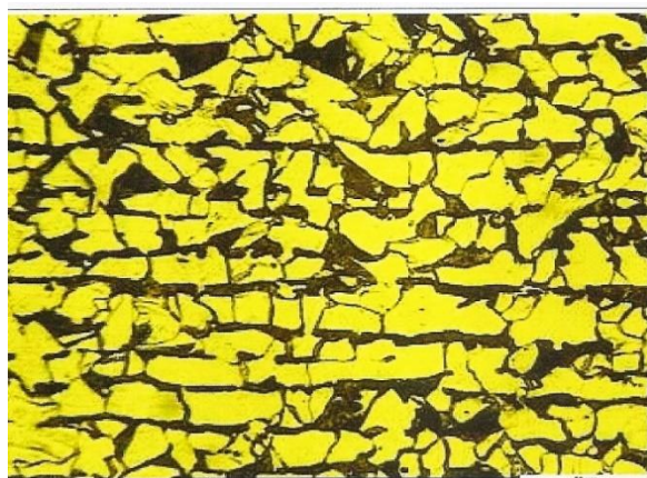
شكل ۱۳ مشاهده ریزدانه پرلیت در زمينه فریت
