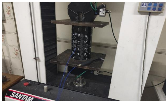
شکل ۶ پیکربندی نمونه برای آزمون همبستگی ارتعاشی.
