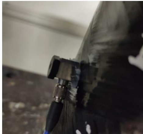
شکل ۴ اتصال شتاب سنج به نمونه.
