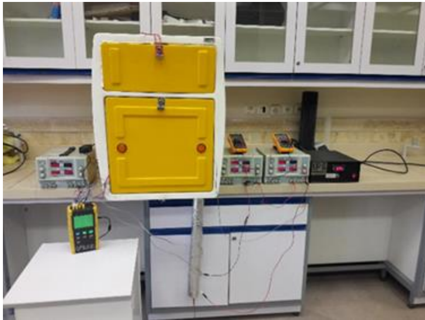
شکل ۸ تصویر شماتیک و مونتاژ شده ترموسیفون و یخچال خنک کننده ترموالکتریک بر روی محفظه.
