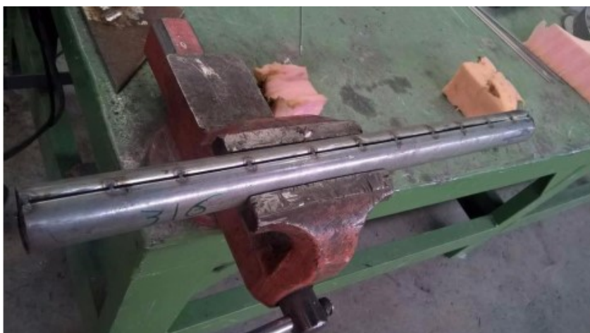
شکل ۱ آماده‌سازی نمونه‌ها جهت انجام عملیات جوشکاری
