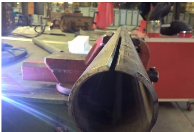
شکل ۲ نوع نمونه قطعه همراه با پخ ۶۰ درجه
