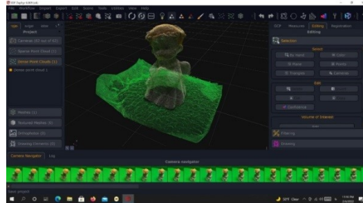
شکل ۶ محیط نرم‌افزار 3DF Zephyr جهت تشکیل ابر نقاط
