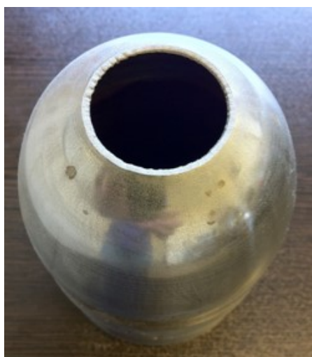
شکل ۱۰ نمونه تغییر شکل داده شده در آزمایش تجربی و شبیه سازی
