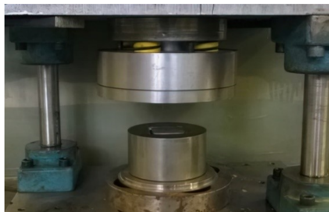
شکل ۴ قالب با ماتریس فلزی برای آزمون تجربی
