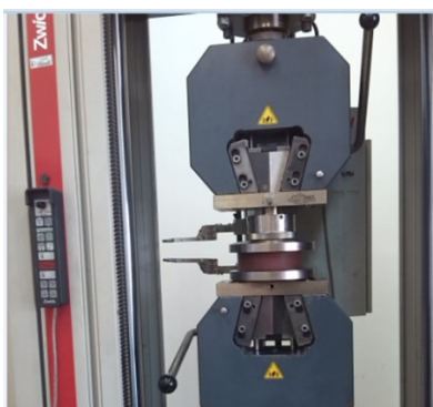
شکل ۱ آزمون فشار برای نمونه لاستیکی
