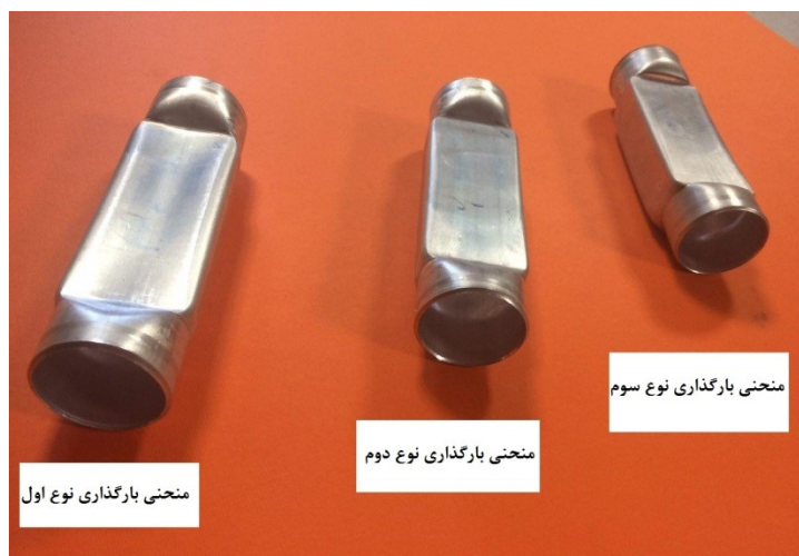
شکل ۱۲ قطعات تولید شده به وسیله هر سه روش بارگذاری
