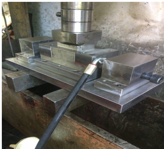
شکل ۱۰ اتصال شلنگ پمپ دستی به سنبه محوری
